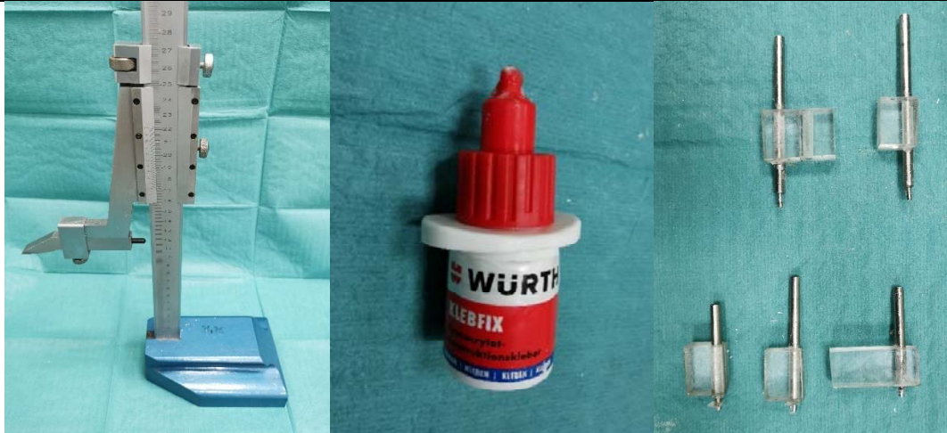
Abbildung 16: Links: Aufreißer; Mitte: Cyanacrylat Kleber; Rechts: Messpins
