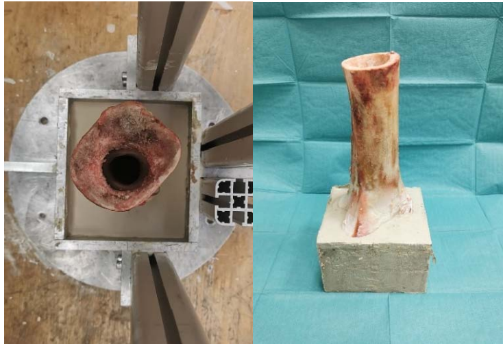
Abbildung 11: Links: Femur in Eingipsschale; Rechts: Femur im Gipssockel
