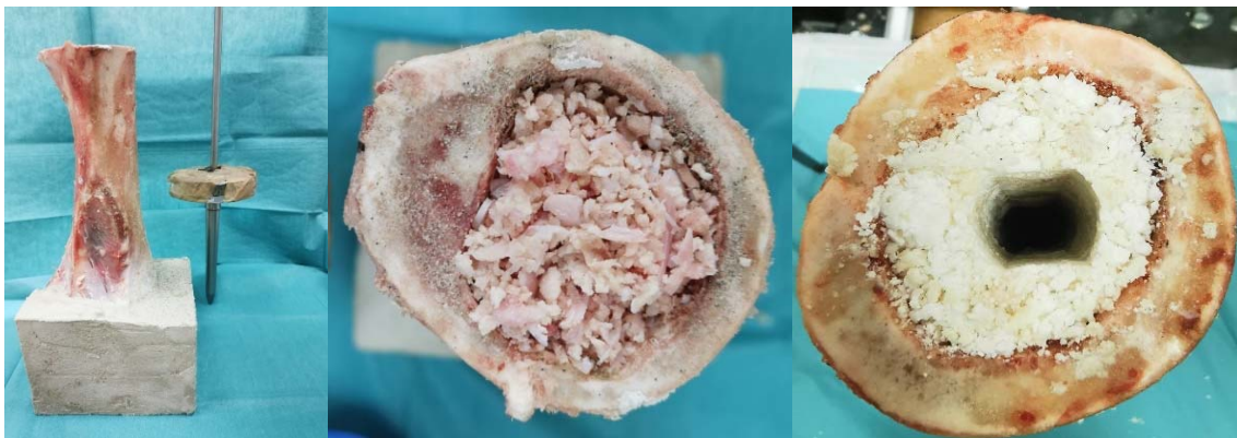
Abbildung 13: Links: Femur mit Impaktor, Fallgewicht und Führungsstab; Mitte: Mit Spongiosachips gefüllter Markraum vor Impaktierung; Rechts: Femur nach Impaktierung
