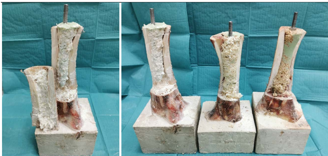
Abbildung 20: Links: Eröffneter Markraum mit eingebrachtem Spongiosa- Zement- Prothesen- Verbund, 66% Palmitatanteil; Rechts: Verschiedene Palmitatanteile, von links nach rechts- 66%, 33%, 0%.
