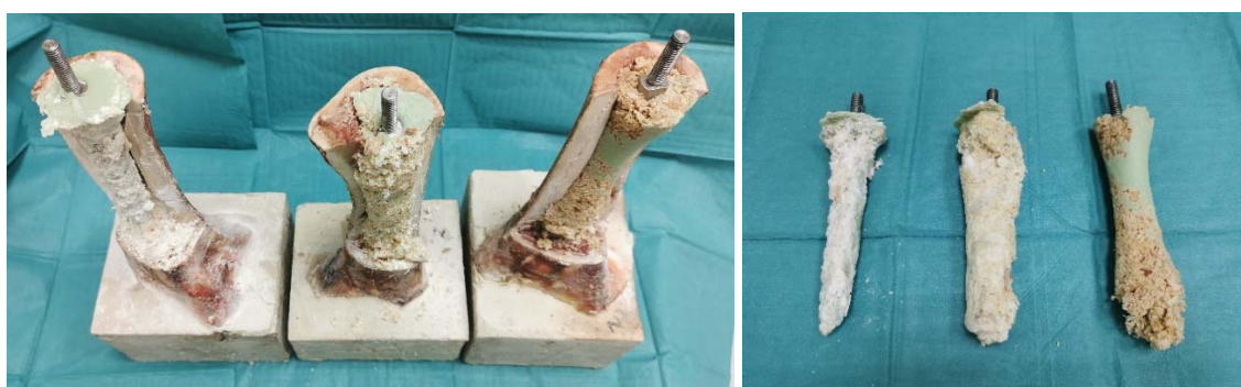
Abbildung 21: Links: Verschiedene Palmitatanteile, Ansicht von oben, von links nach rechts- 66%, 33%, 0%; Rechts: Spongiosa- Zement- Mantel bei unterschiedlicher Palmitatbeimengung, von links nach rechts- 66%, 33%, 0%.
