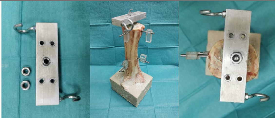
Abbildung 18: Links: Hebelarm; Mitte: Modell mit Messpins und Hebelarm- Seitansicht; Rechts: Modell mit Messpins und Hebelarm- Ansicht von oben
