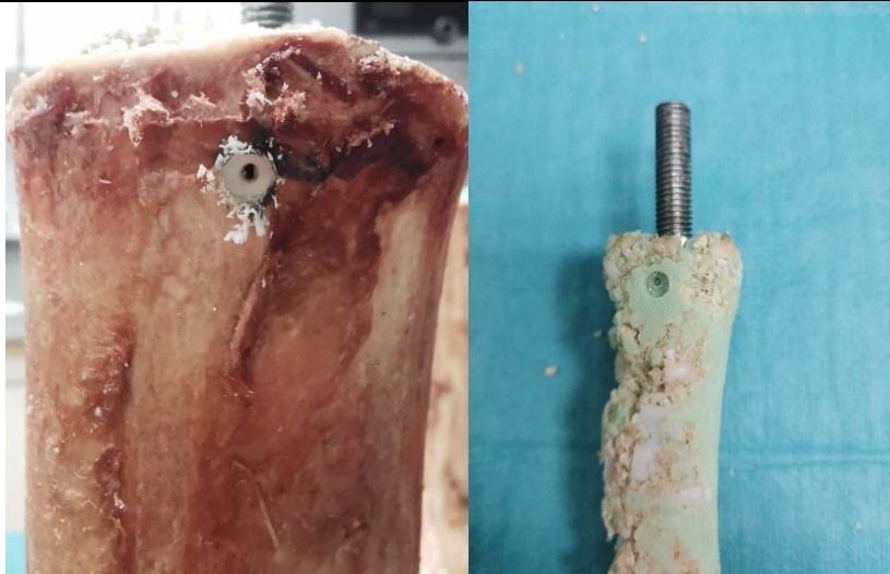
Abbildung 17: Links: Bohrung für Kortikalispin; Rechts: Bohrung für Zementpin
