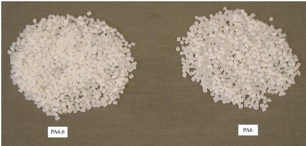
Abb. 4-1 Polyamid 6 und Polyamid 6.6 Granulat
