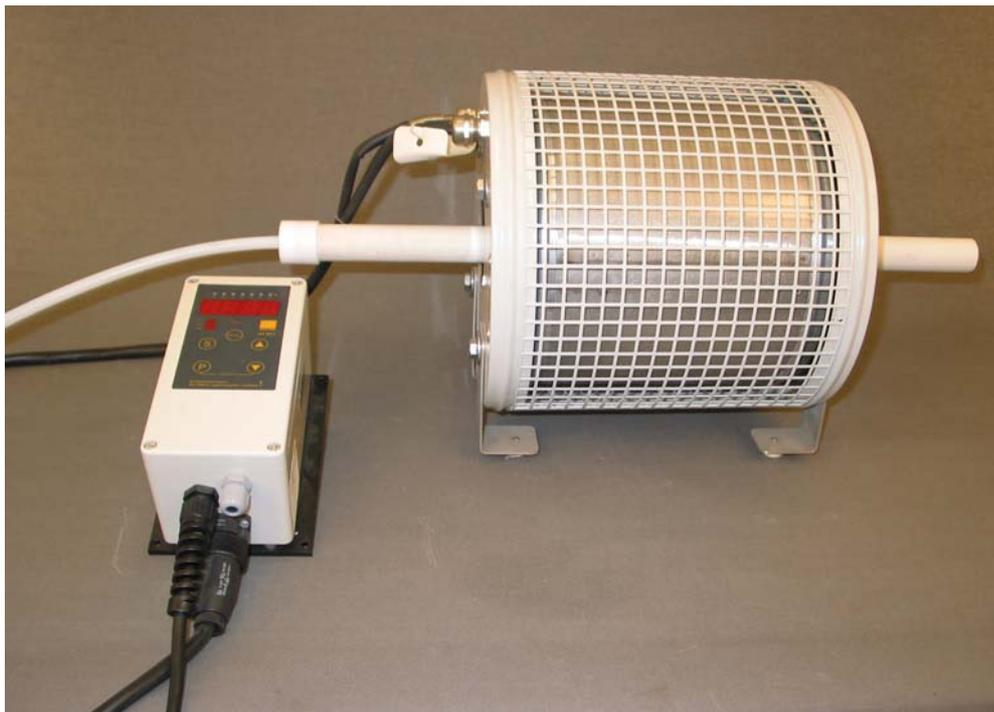
Abb. 4-3 Röhrenofen (incl. Temperaturregeleinheit) zum Verschwelen der Polymerproben mit eingeleitetem Keramikrohr und Schlauch für die Gaszufuhr
