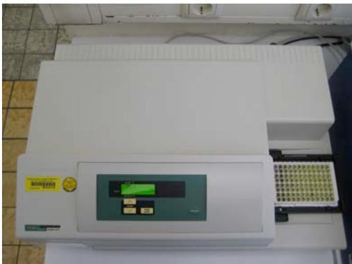
**Abbildung 6:** Spektrophotometer zur Absorptionsmessung.
