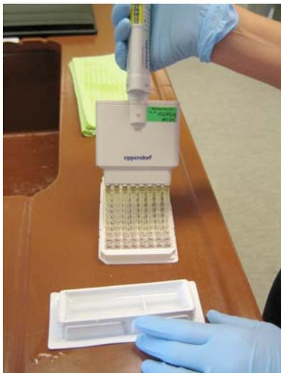
**Abbildung 3:** Waschen der Vertiefungen mit 8-fach Pipette
