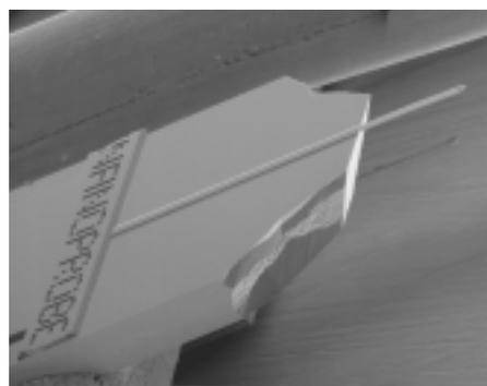
Abbildung 3.9.: REM-Aufnahme eines Hebelarms.
