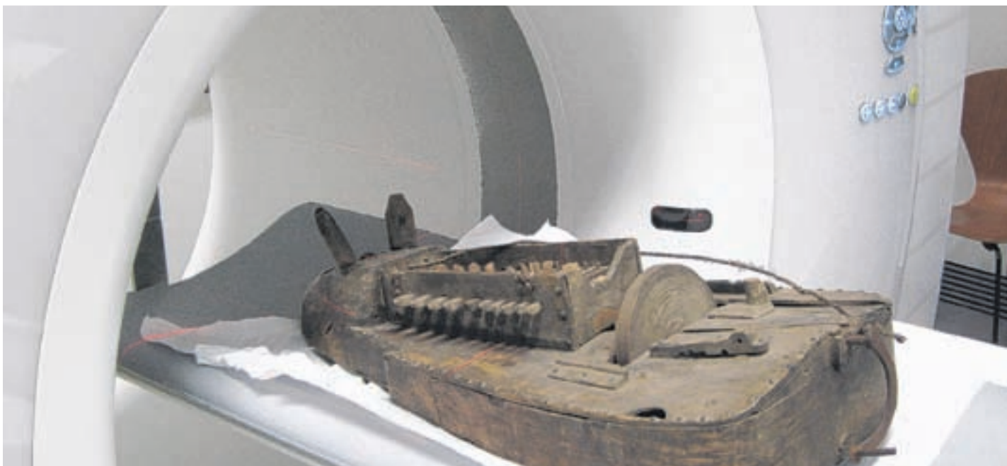
Scan einer mittelalterlichen Drehleier mittels eines Spiral-Computertomographen.
