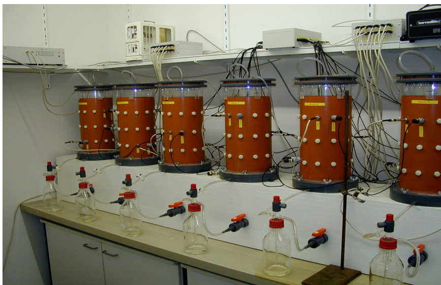
Abb. 3-2b: Aufbau der Kleinlysimeteranlage im Labor
