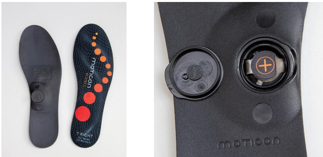
Abbildung 10: Sohlenpaar in Größe 7 (EU: 44/45) (links); eröffnetes Batteriefach (rechts)
