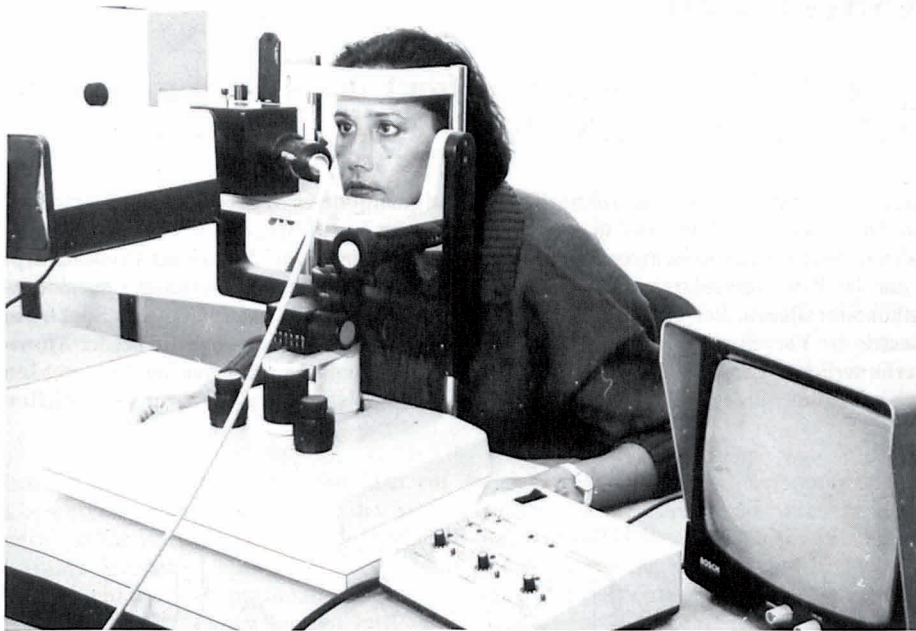
Abb. 5: Gesamtübersicht über das Fluoreszenzspektrometer.
