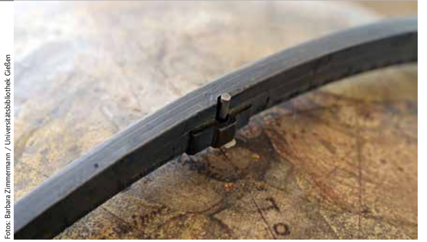
Detail des restaurierten Himmelsglobus: An den Polen befinden sich Achsstifte und Metallplättchen, mit denen die Kugel am Messingmeridianring fixiert ist und gedreht werden kann.
