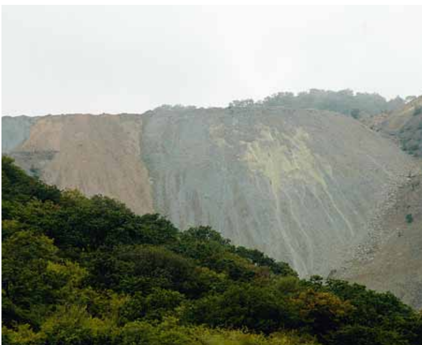
■ Abb. 2a (links): Abraumhalde des Erztagebaus mit deutlichen Spuren der Erosion. Abb. 2b (oben): Das mit Schwebfracht belastete Wasser in einem Zufluss zum Mashavera ist durch die Oxidation sulfidischer Erzpartikel stark versauert und mit Schwermetallen belastet.
