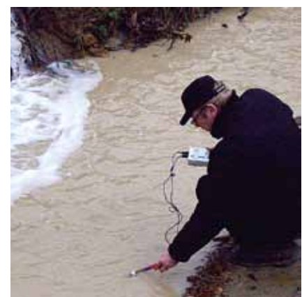
■ Abb. 2a (links): Abraumhalde des Erztagebaus mit deutlichen Spuren der Erosion. Abb. 2b (oben): Das mit Schwebfracht belastete Wasser in einem Zufluss zum Mashavera ist durch die Oxidation sulfidischer Erzpartikel stark versauert und mit Schwermetallen belastet.
