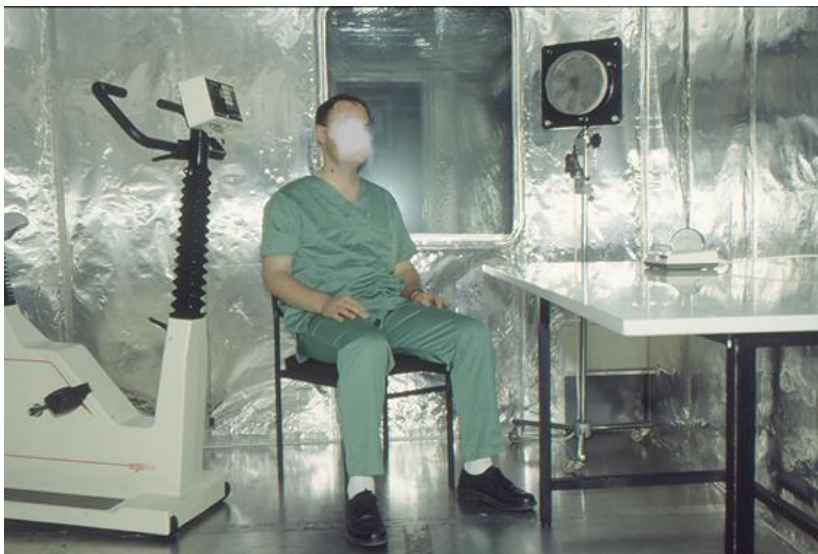
Abbildung 2: Beispielhafte Exposition in einer Expositions-kammer mit Fahrradergometer und Ventilator [38].
