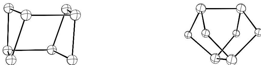
Abb. 1.4: Die Ionen \text{Te}_8^{4+} in \text{Te}_8[\text{VOCl}_4]_2 (links) und „ (\text{Te}_4\text{S}_4)^{2+} “ in (\text{Te}_4\text{S}_4)[\text{AsF}_6]_2 \cdot \text{SO}_2 (rechts), in dem Tellur-Atome die dreifach koordinierten Positionen besetzen.
