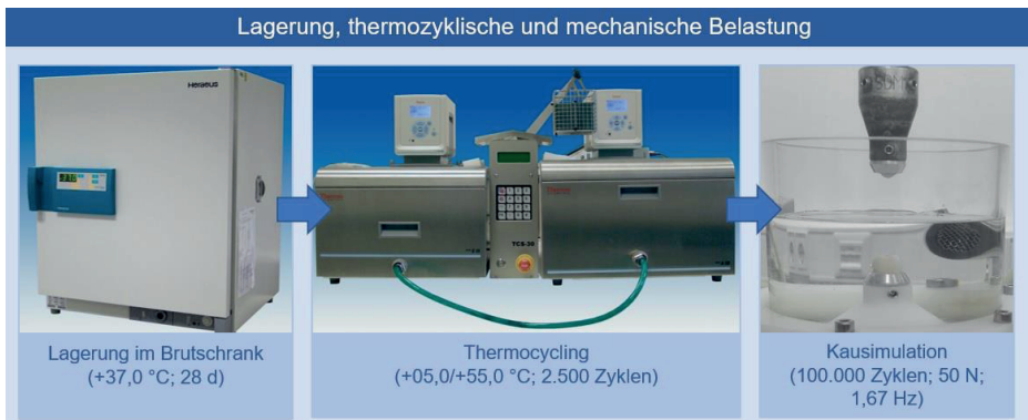
Abbildung 5: Schematische Darstellung der Lagerung, der thermozyklischen und der mechanischen Belastung
