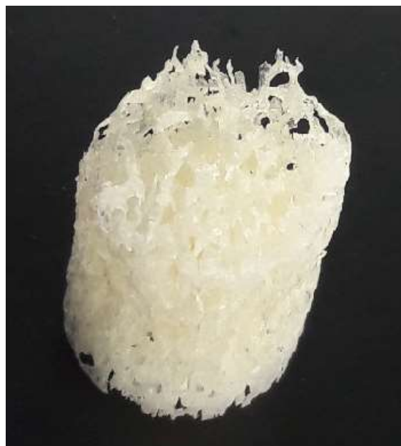
Abbildung 24: Nachdruck einer Humerusprobe aus Durus nach dem Entstützen
