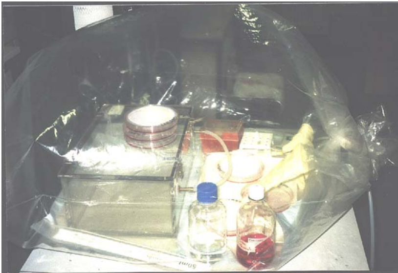
Abb. 3: Fotografie des Versuchsaufbaus. Man sieht den mit Gasgemisch gefüllten Hypoxiesack, in dem die Hypoxiekammer, die Zellkulturplatten und die verschiedenen Versuchsmedien, neben Verbrauchsmaterial stehen.
