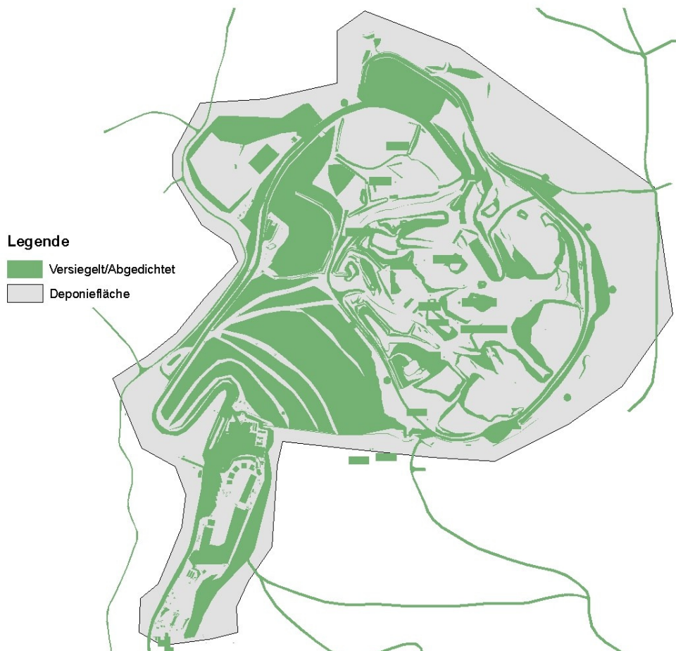
Abb. 3.3: Deponiefläche der Abfallentsorgungsanlage ABlar mit abgedichteten/versiegelten Bereichen
