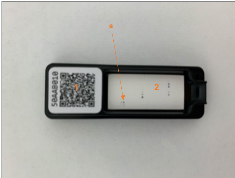
Abbildung 2: Api m 10 Peptid Array (Firma Macro Array Diagnostics GmbH (MADx), Wien, Österreich. (1) Individueller Barcode des Chips, der mit Hilfe des MADx ImageXplorers gelesen und anschließend in der Raptor Analyse Software einem Patienten zugeordnet werden kann. (2) Auf der dargestellten Membran befinden sich gebunden Api m 10-Peptide und die rekombinanten Bienengift-Einzelallergene Api m 1, Api m 2, Api m 3, Api m 4 und Api m 10. Hier erfolgt die Zugabe der jeweiligen Patientenseren, des ALEX® Sample Diluents, der ALEX® Washing Solution, des ALEX® Detection Antibody sowie der ALEX® Stop Solution. (*) Exemplarisch markierter farblicher Punkt, welcher die Antikörperreaktivität mit dem jeweiligen Antigen anzeigt.
