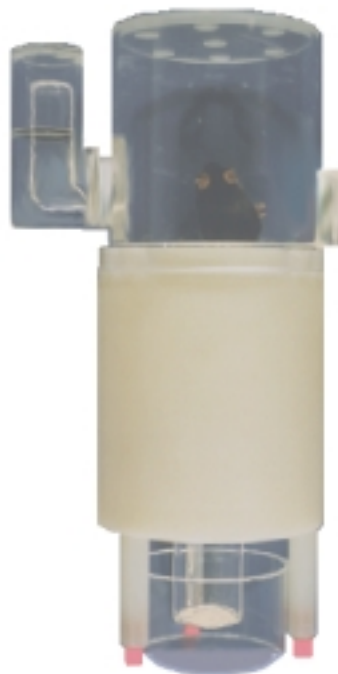
Abb. 20 Stoffwechselkäfig für Mäuse mit Vorrichtung zur getrennten Sammlung von Urin und Faeces
