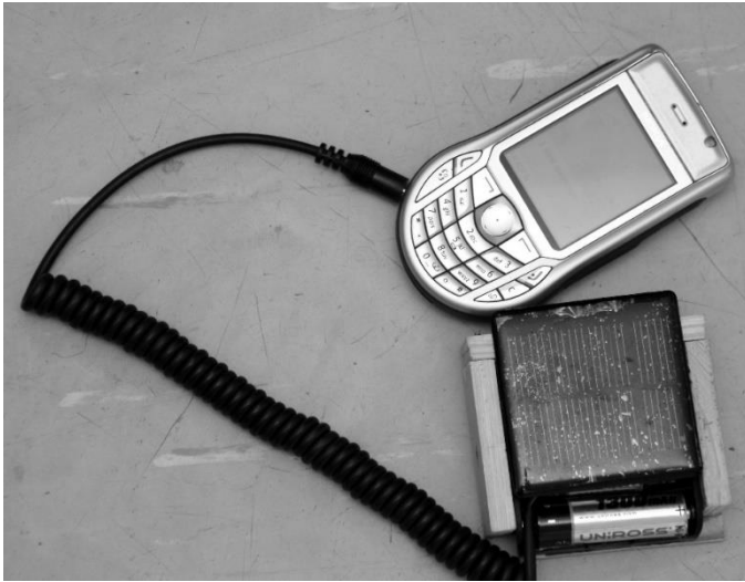
Abb. 17: Zum Aufladen des Telefons benutzt sie Batterien und ein Solarmodul. (dito)
