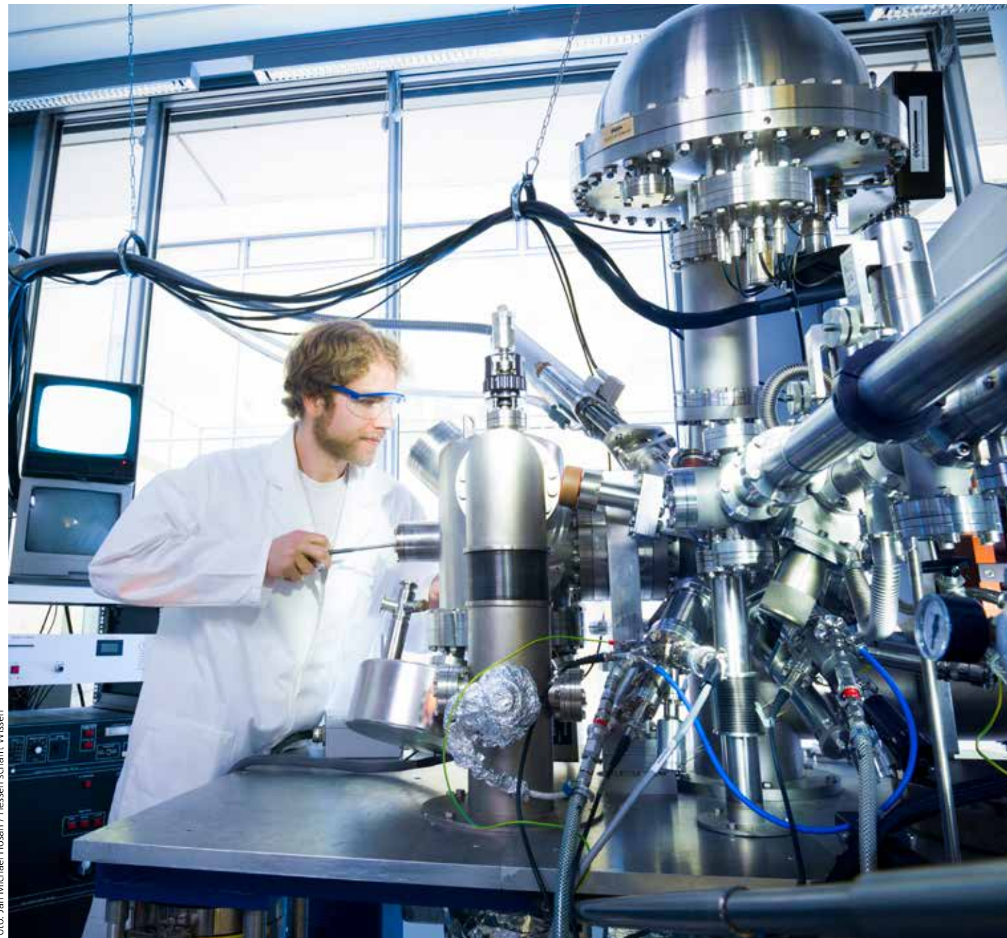
Christian Sack aus der AG von Prof. Janek untersucht Funktionsmaterialien mittels Röntgenphotoelektronenspektroskopie (XPS). Das Team nutzt diese und andere Ultrahochvakuum-Methoden, wie Sekundärionenmassenspektrometrie (SIMS) und Rasterelektronenmikroskopie (HREM).
