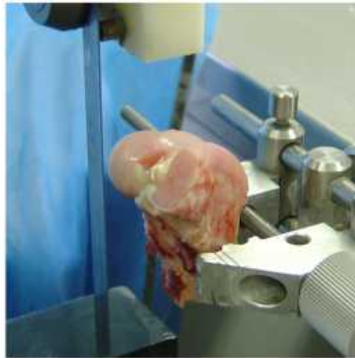
Abb. 18: Hundeknie mit Bandsäge (Exakt, Norderstedt), Labor für Experimentelle Unfallchirurgie, Universitätsklinikum Giessen und Marburg, Standort Giessen.
