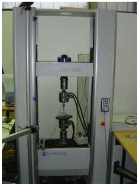
Abb. 19: Elektromechanische Universalprüfmaschine vom Typ Inspect 100, Institut für Werkstofftechnik der Universität Siegen.
