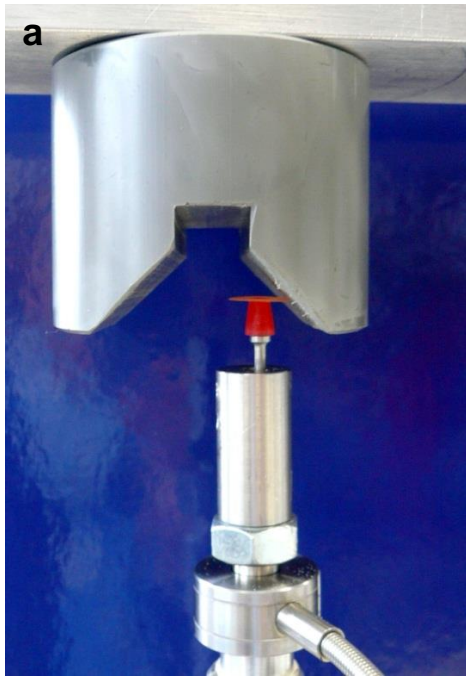
Abbildung 14: Versuchsanordnung zur Ermittlung der Kraft beim Anpressen der Discs gegen eine schiefe Ebene; Flexi-Snap Disc mit initialem Kontakt zu der Testfläche beim Beginn der Messung (a) und bei zunehmendem Kontakt während der Messung (b).
