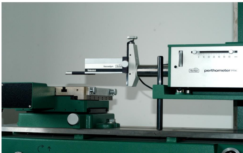
Abbildung 11: Optischer Mikrotaster Focodyn zur Erfassung der Mikrostruktur der abzutastenden Oberfläche, gekoppelt an das Vorschubgerät PRK. Am linken Rand der vollautomatisch gesteuerte Vorschubtisch zur Ausführung des Modus Parallelaufzeichnung.
