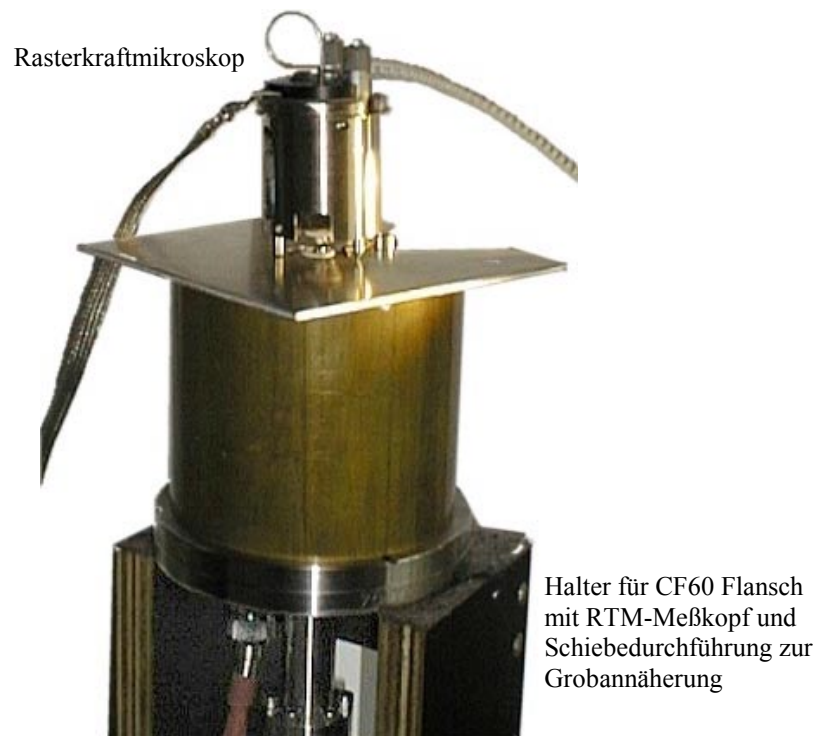
Abb. 6: Aufbau zur Kalibrierung des RTM-Rasteraktuators mit Hilfe des Rasterkraftmikroskops
