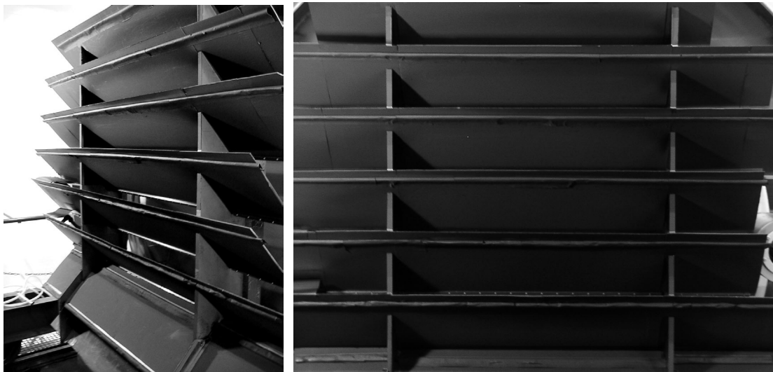
Abbildung 2-6 Wassergekühltes und mit Graphit verkleidetes Strahltarget
