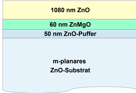
Abbildung 4.14: Schematische Darstellung einer ZnO-Schicht auf m-planarem ZnO.
