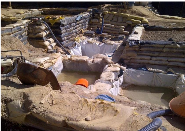
Abbildung 58: Ungeschützte Cyanidlaugebecken illegaler Bergleute am Cerro El Toro
