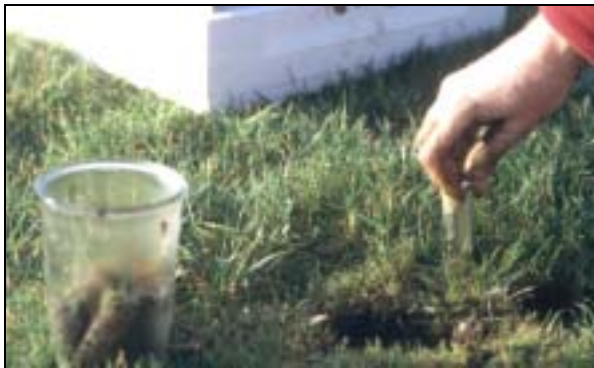
Abbildung 2.9-A: Probennahme (links) und in-situ -Inkubation der Bodenproben im Sandbeet (rechts) mit und ohne 5 bis 10 Pa \text{C}_2\text{H}_2 zur Trennung von \text{N}_2\text{O} -Emissionen aus Nitrifikation und Denitrifikation (Methodik nach MÜLLER et al. 1998).
