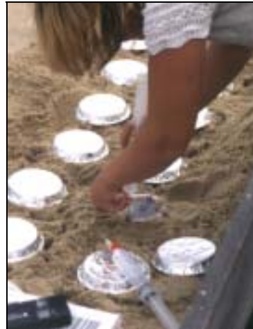
Abbildung 2.9-A: Probennahme (links) und in-situ -Inkubation der Bodenproben im Sandbeet (rechts) mit und ohne 5 bis 10 Pa \text{C}_2\text{H}_2 zur Trennung von \text{N}_2\text{O} -Emissionen aus Nitrifikation und Denitrifikation (Methodik nach MÜLLER et al. 1998).
