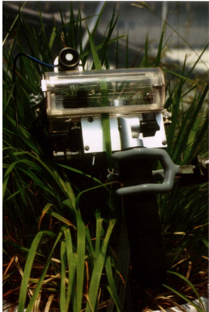
Abb. 13: Gaswechselformung an einem in die Messkuvette des LI-6200 eingespannten Blatt von Brachypodium pinnatum (14.6.1996, Topf Nr. 181, Kammer 3, \text{NH}_3 -Konzentration 50 \mu\text{g m}^{-3} ).
