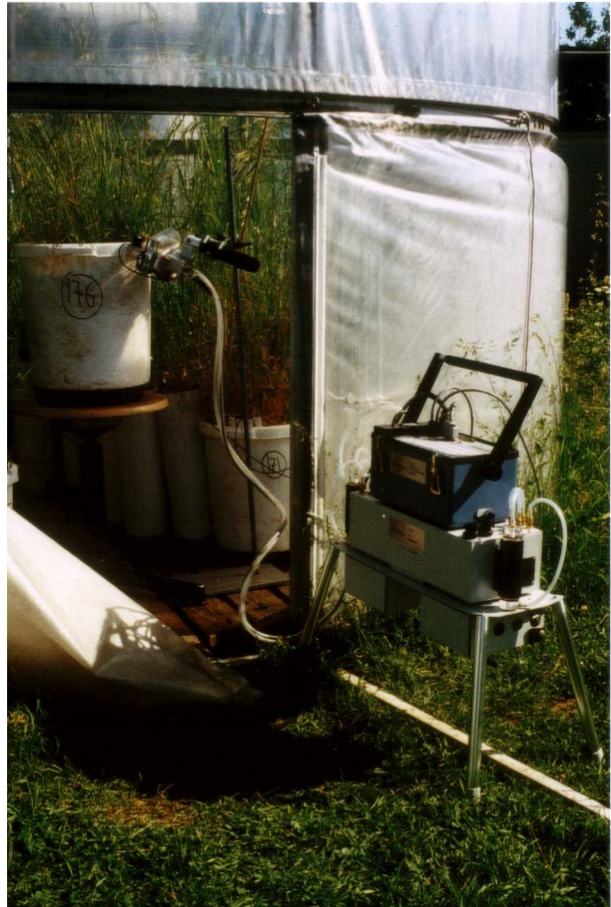
Abb. 12: Gaswechselfmessung mit dem tragbaren Porometer LI-6200. Die Messküvette wurde mittels eines Laborstativs so fixiert, dass ein zu messendes Blatt gut eingespannt werden konnte. Während der eigentlichen Messung war die Open-Top-Kammer geschlossen (13.6.1996, Topf Nr. 176, Kammer 3, \text{NH}_3 -Konzentration 50 \mu\text{g m}^{-3} ).
