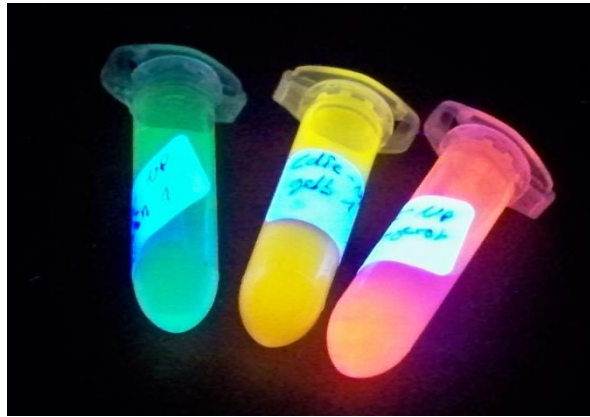
Abb. 105: Aufnahme unter der UV-Lampe ( \lambda = 366 \text{ nm} ) der in diesem Projekt verwendeten Qdots mit MUDA-Hülle (grün), MHA-Hülle (gelb), MPA-Hülle (orange).
