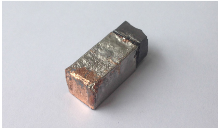
Abbildung 25: Ein Kupferblock des Probenhalters mit angelöteter \text{FeCo}_{0.05}\text{Si}_{1.95} -Probe nach einem misslungenen Lötvorgang. Durch eine zu hohe Temperatur während des Lötvorganges ist es zu einer Veränderung des Blockes gekommen. Die Probe ist aufgrund hoher innerer Spannungen gebrochen.
