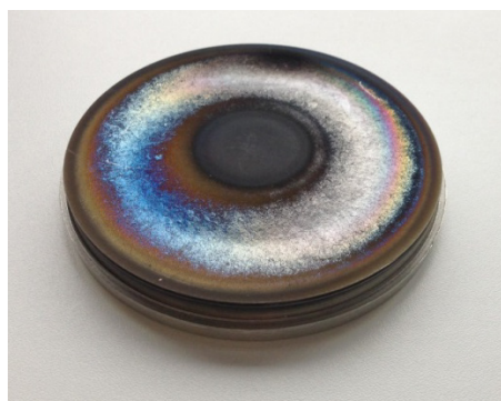
Abbildung 29: Gebrauchtes Target für das Magnetronspütern. Erkennbar sind die kreisförmigen Vertiefungen der Materialauslösung aufgrund der Elektronenbewegung oberhalb der Oberfläche.
