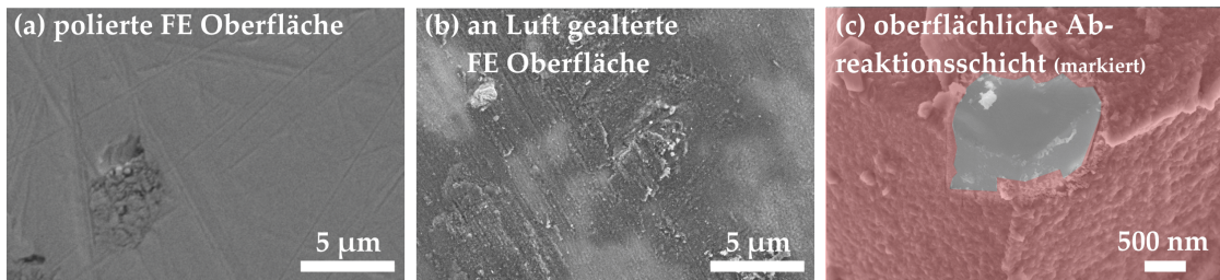
Abbildung 4.11: HREM-Aufnahme einer gealterten Festelektrolytoberfläche. (a)/(b) Alterungseffekt an der Oberfläche; (c) Bruchkante an der die Abreaktionsschicht zu erkennen ist (Probe LLTZO_04).
