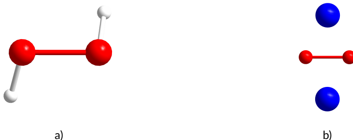
Abbildung 5.31: Stabile Grundzustandsstrukturen für die Moleküle a) \text{H}_2\text{O}_2 und b) \text{Li}_2\text{O}_2 optimiert auf dem CASSCF/CASPT2-Niveau (Wasserstoff – weiß, Sauerstoff – rot, Metall (Li) – blau).
