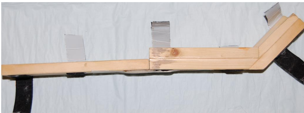
Abbildung 12: Lagerungshilfe aus Holz mit Klettmanchetten für das Ellbogengelenk eines Hundes zur computertomographischen Untersuchung
