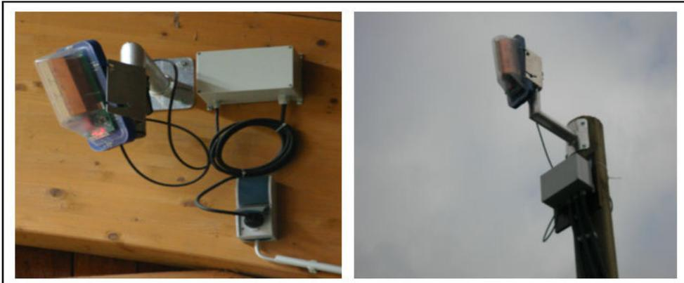
Abbildung 20: Installation der Transponder im Stall (links), sowie auf der Weide (rechts).
