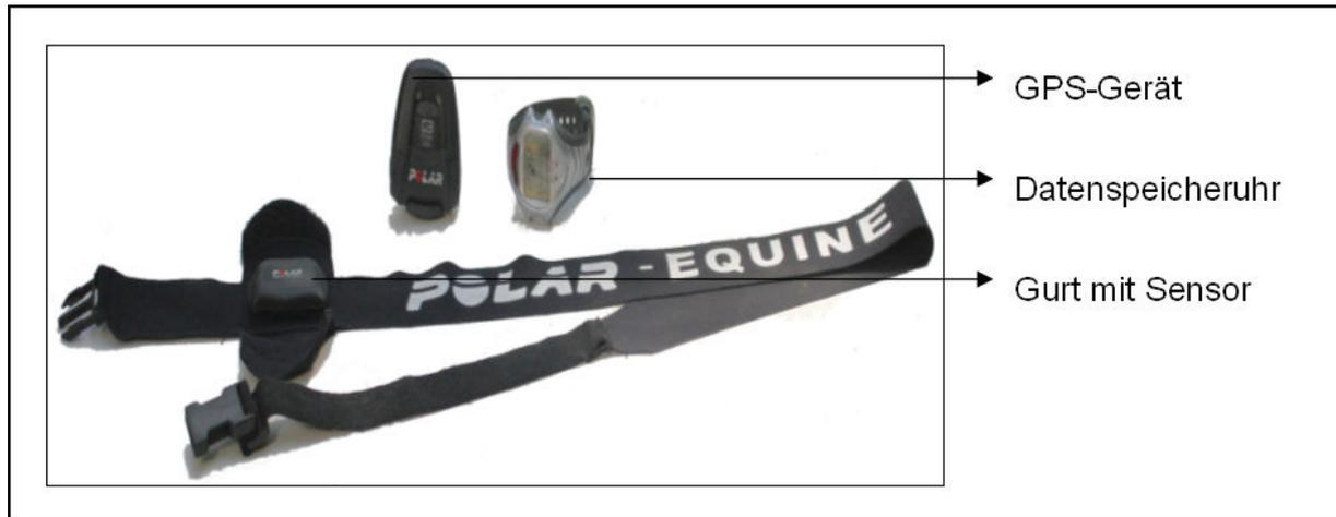
Abbildung 18 : GPS-Gerät, bestehend aus GPS-Empfänger, Datenuhr und Bauchgurt.
