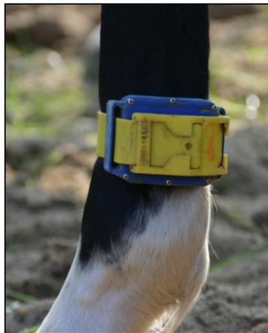
Abbildung 17: Anbringung und Position eines Pedometers am Pferdebein.
