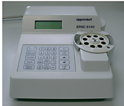
Abbildung 4: Spektralphotometer EPAC 6140 Eppendorf
