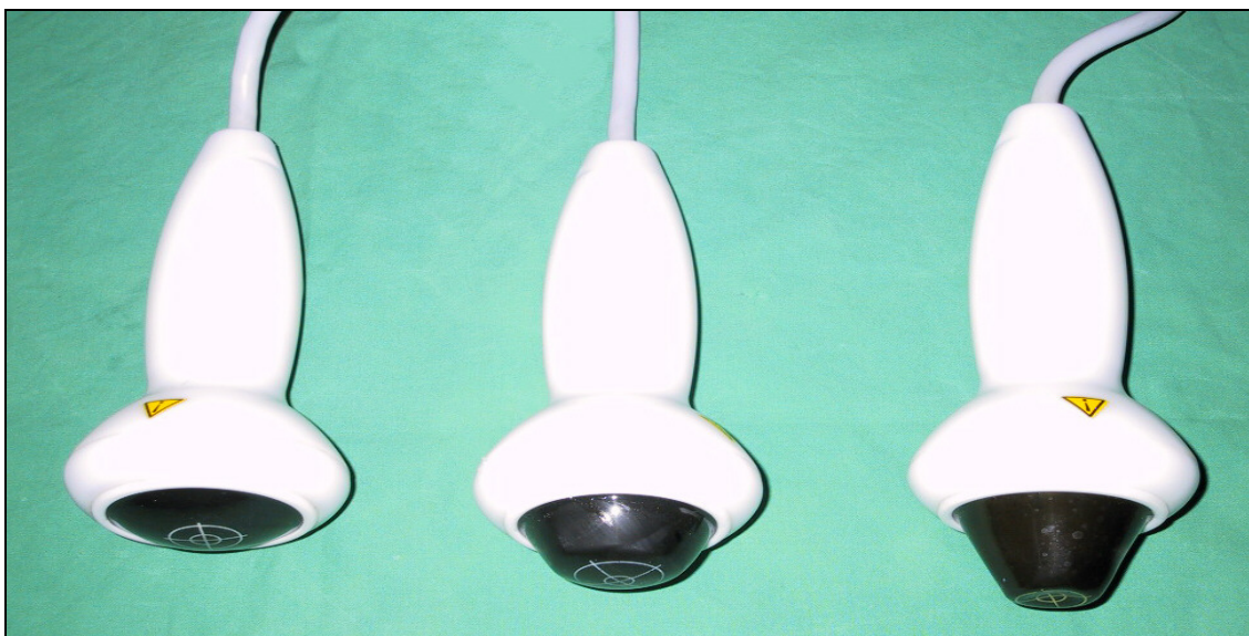
Abbildung 18: Therapieköpfe des „Equitron“ © mit unterschiedlicher Apertur. Therapieköpfe mit einer Fokustiefe von 5 mm, 20 mm und 35 mm (von links nach rechts).
