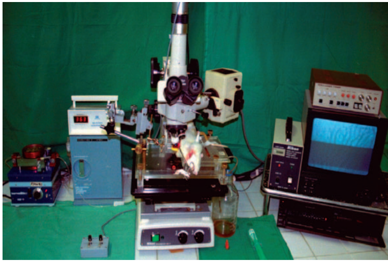
Abb.7 Mikroskop- Videoeinheit zur Intravitalmikroskopie
