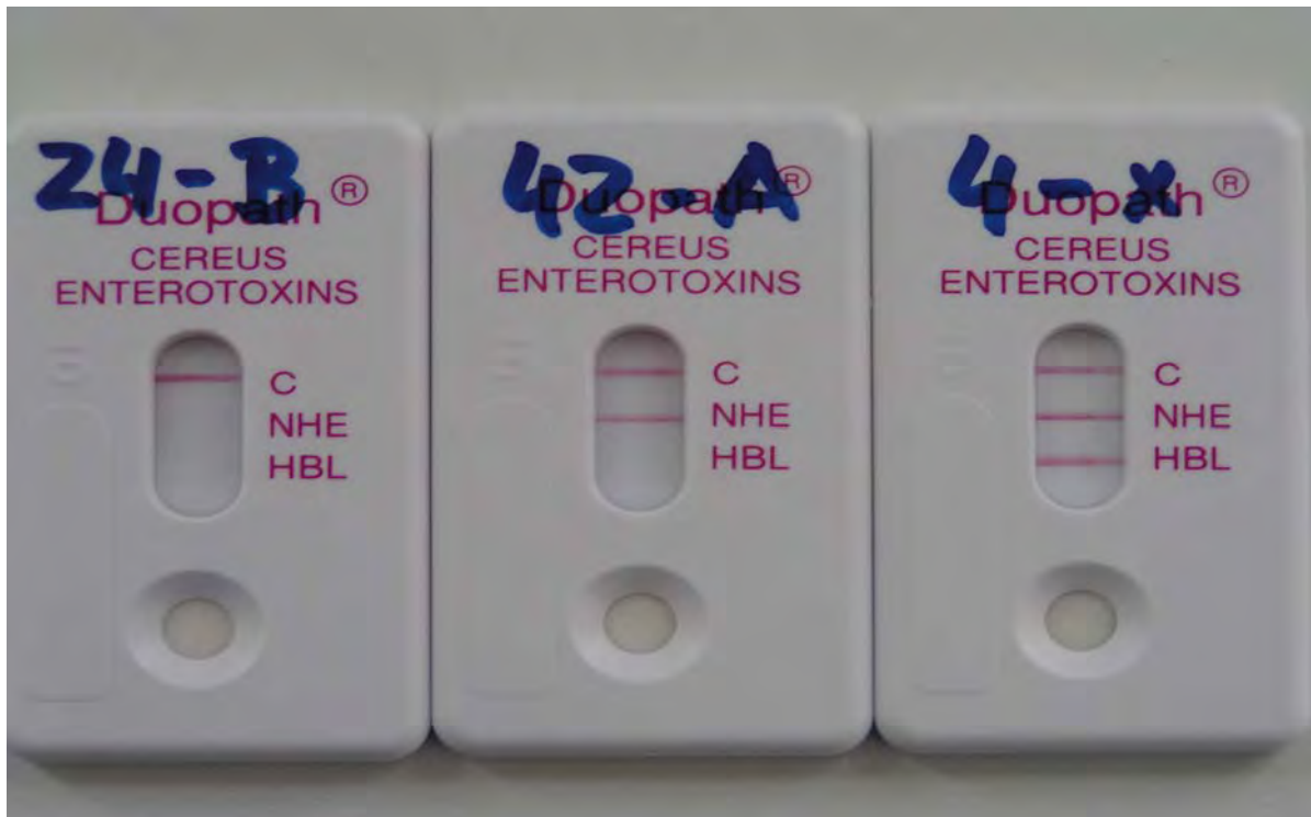
Abb. 11: Beispiele für mittels des Duopath® Cereus Enterotoxins Test negativ getestete Bacillus spp. (links), Nhe-positive Bacillus spp. (Mitte) sowie Nhe- und Hbl-positive Bacillus spp. (rechts). Eine 30 Minuten nach Beginn der Testdurchführung sichtbare rot gefärbte Linie der Kontrollzone “C“ zeigt die Funktionsfähigkeit des Tests an, das gleichzeitige Vorhandensein von eindeutig rot gefärbten Linien in den Testzonen (“NHE“ bzw. “HBL“) führt zur Bewertung der untersuchten Probe bzw. des getesteten Isolates als positiv bezüglich der Ausbildung der jeweiligen B. cereus -Enterotoxinkomponenten.
