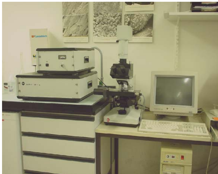
Abb. 4: Mikrodensitometer mit Stereomikroskop und Computer
