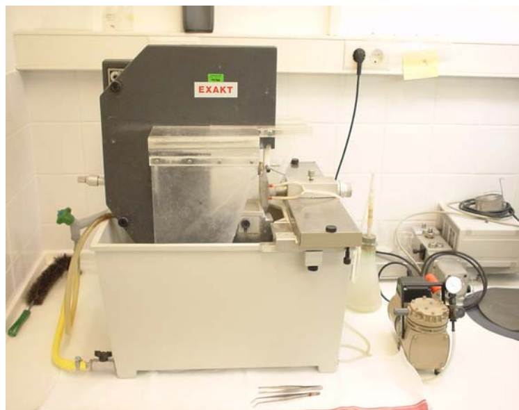
Abb. 1: Exakt-Trennschleifsystem mit Vakuumpumpe
