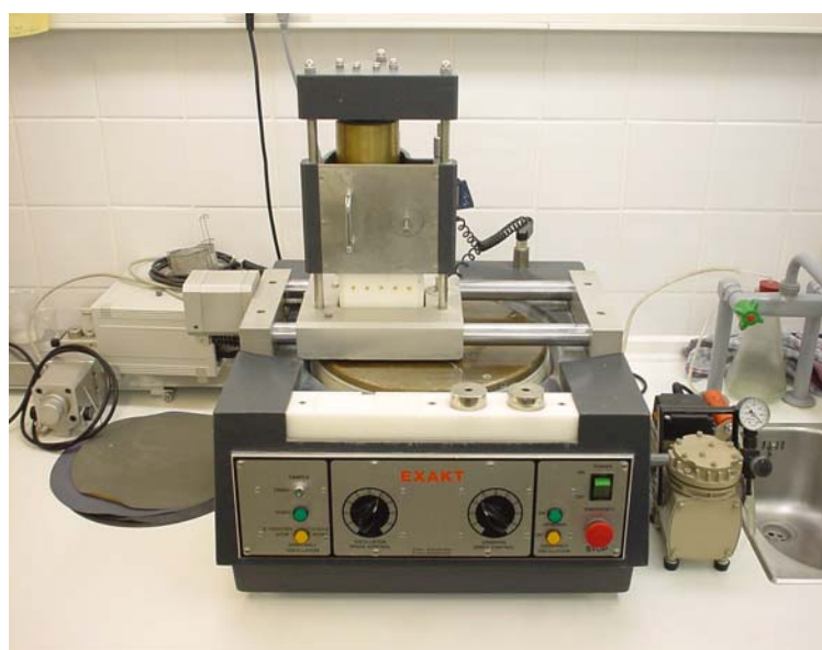
Abb. 2: Exakt-Mikroschleifsystem mit Vakuumpumpe und Schleifpapier
