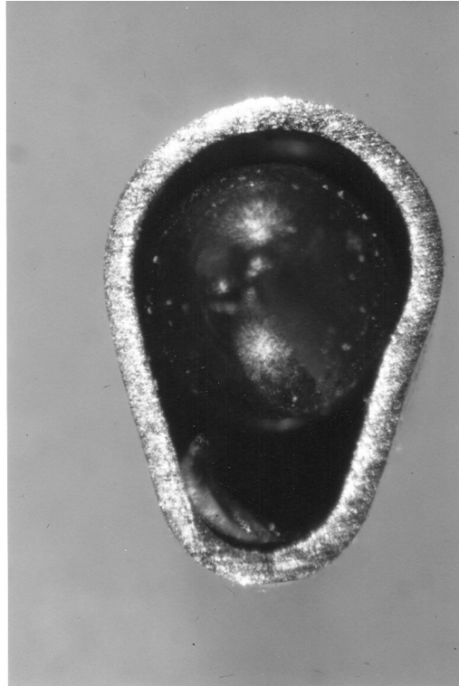
Abb. 3: Makroaufnahme des tropfenförmigen Querschnitts einer 18G Epistar-Kanüle der Firma Rüsç.
