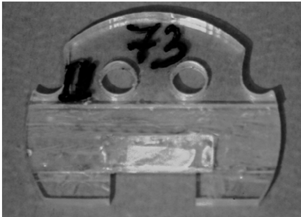
Abb.5: Beispiel einer Probe (TMR) im Mikroradiographiehalter
