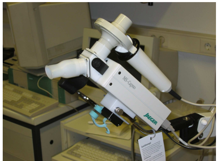
Abb. 2.1: MasterScreen Capno System (Fa. Jaeger-Toennis, li.) und Messeinheit (re.), bestehend aus schnell ansprechendem CO 2 -Analysator (Nebenstromverfahren) und nachgeschaltetem Pneumotachograph, verbunden durch ein spezielles Winkelstück, an das auch das Mundstück angeschlossen wird.
