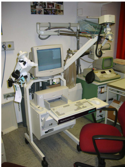
Abb. 2.1: MasterScreen Capno System (Fa. Jaeger-Toennis, li.) und Messeinheit (re.), bestehend aus schnell ansprechendem CO 2 -Analysator (Nebenstromverfahren) und nachgeschaltetem Pneumotachograph, verbunden durch ein spezielles Winkelstück, an das auch das Mundstück angeschlossen wird.
