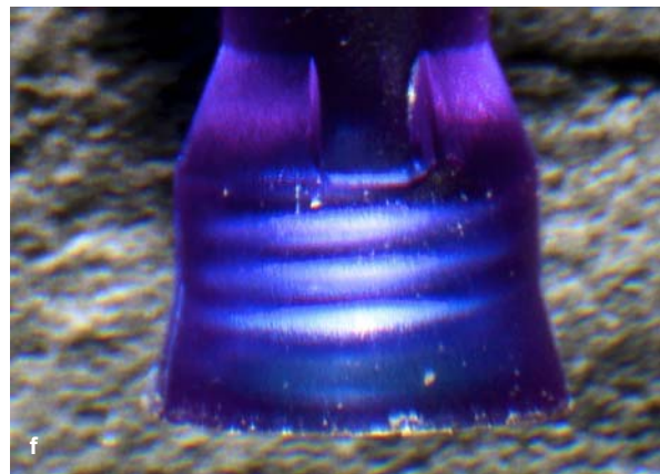
(e) Detailansicht der optimierten Spitze des Sonic Pins für die Ultraschallinsertion. (f) Detailansicht des Kopfes mit Innengewinde zum Anschluss der Ultraschallsonotrode des Sonic Pins.
