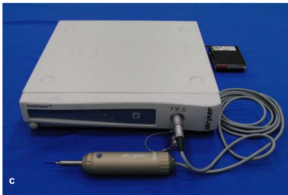
(c) Ultraschallkonsole mit Handstück und Fußschalter. (d) Pin Instrumente: Abschneidevorrichtung, Bohrer, Dilator, Sonic Pin konnektiert an der Sonotrode des Ultraschallhandstück.
