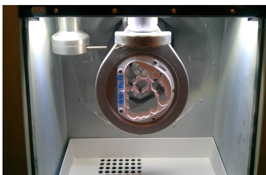
Abb. 2.10 Eingespannter Rohling in Fräsmaschine (links) und Anordnung im Blank (rechts)
