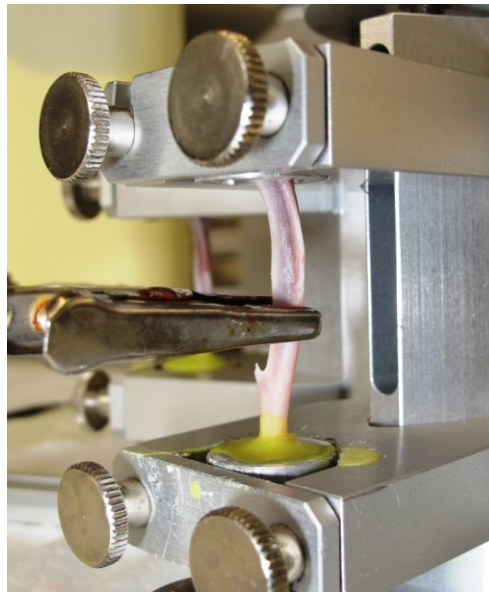
Abb. 19: Die Tibia in der Eingießvorrichtung. Das distale Ende ist in Technovit ® eingebettet.
