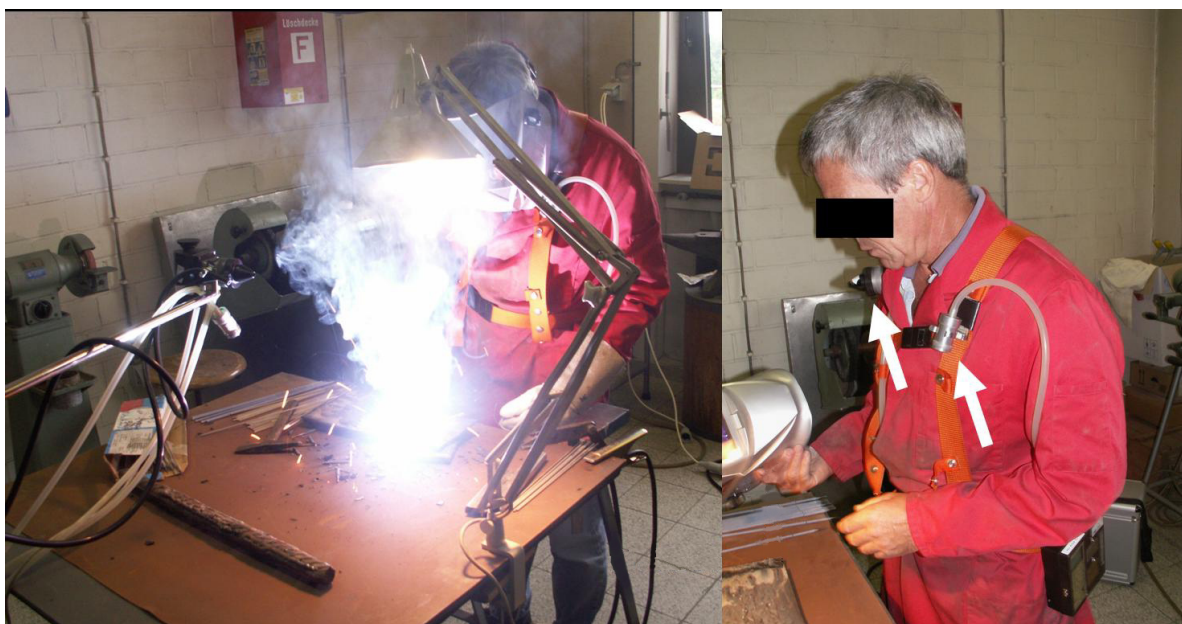
Abbildung 3.4 Schweißearbeitsplatz: das linke Bild zeigt die Ausrichtung der stationären Messköpfe während des Schweißens, rechts ist die Positionierung der personenbezogenen Messköpfe (Markierung durch Pfeile) abgebildet
