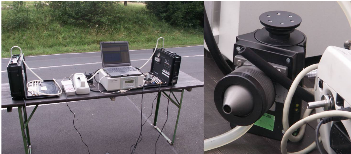
Abbildung 3.5 Messanordnung zur Erfassung verkehrsbedingter Dieselrußpartikel. Links: Aufbau, bestehend aus Pumpe, Datenlogger des Respicon-Gerätes, CPC-Gerät, Respicon-Gerät, NSAM-Gerät mit Laptop und einer weiteren Pumpe (von links nach rechts). Rechts: Die unmittelbar in räumlicher Nähe angebrachten Ansaugöffnungen der unterschiedlichen Messgeräte
