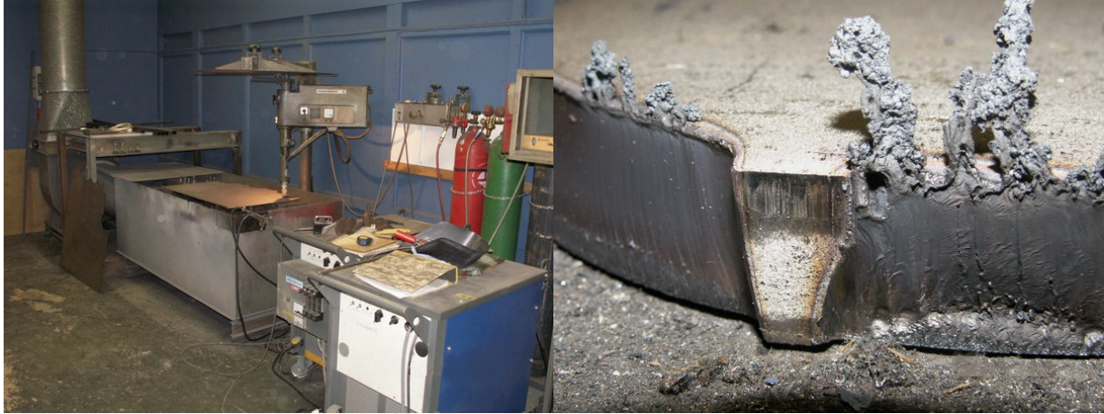
Abbildung 3.7 Links: Plasmaschneideanlage; Rechts: Schnittkante einer durchtrennten Edelstahlscheibe
