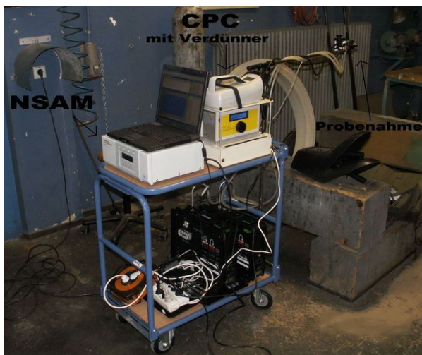
Abbildung 3.1 Mobiler Messwagen für stationäre Messungen
