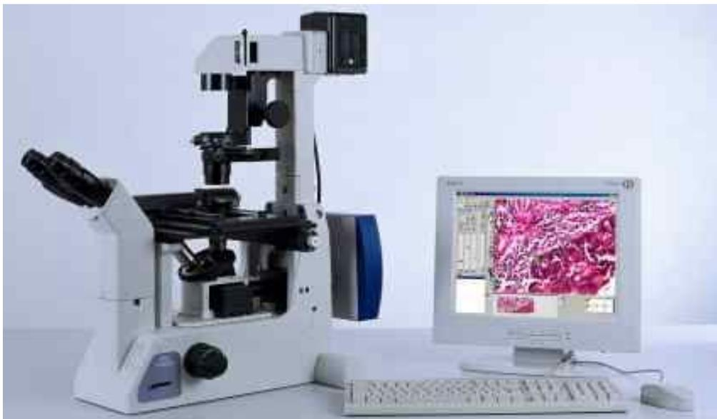
**Abb. 10:** Aufbau des PALM-UV-Laser MicroBeam-Systems
