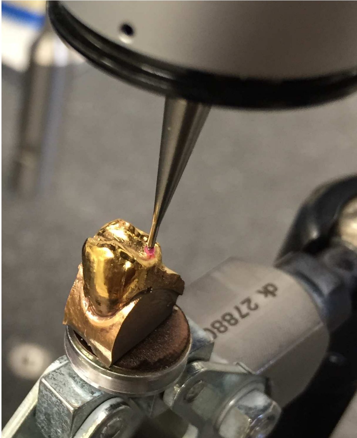
Abb. 11 Abtastvorgang durch 3D-CNC-Messmaschine. Der Taster mit der roten kugelförmigen Spitze fährt von bukkal nach lingual über die Oberfläche des Modells und registriert die Bahn in einer Serie von Punkten. Sobald der Taster lingual am kaudalen Ende des Modells gelangt ist, fährt der Taster von lingual nach bukkal zurück, jedoch in der x-Achse leicht nach medial versetzt (zwischen 50-1000 \mu\text{m} ). Kaudobukkal wieder angelangt, setzt der Taster, erneut etwas weiter medial an einer REM (Rasterelektronenmikroskop)-Trägerplatte befestigt und in der Halterung des Tasters eingespannt, die Messbahnen fort bis die gesamte Oberfläche des Zahnmodells erfasst ist.
