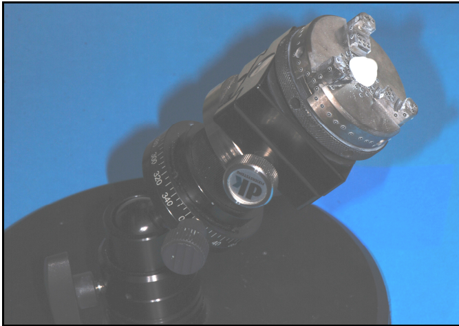
Abb. 4.14: Eingespannter Antagonist im drehbaren Fixierungshalter
