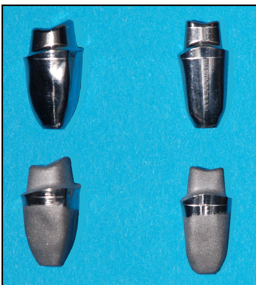
Abb. 4.4: Titanstümpfe im Vergleich: ohne Sandstrahlung (oben), mit Sandstrahlung (unten)
