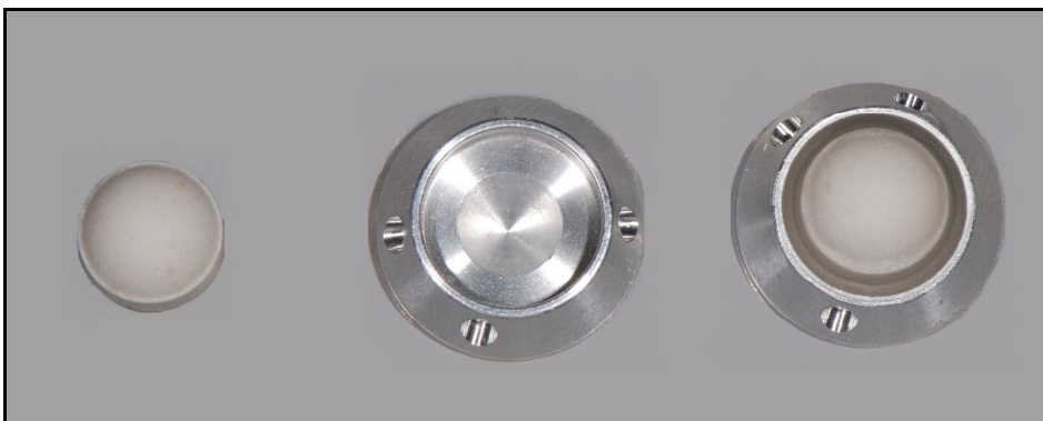
Abb. 4.2: Antagonisteneinbettung: Steatitkugel (links), Antagonistenhalter (mitte), eingebettete Steatitkugel (rechts)
