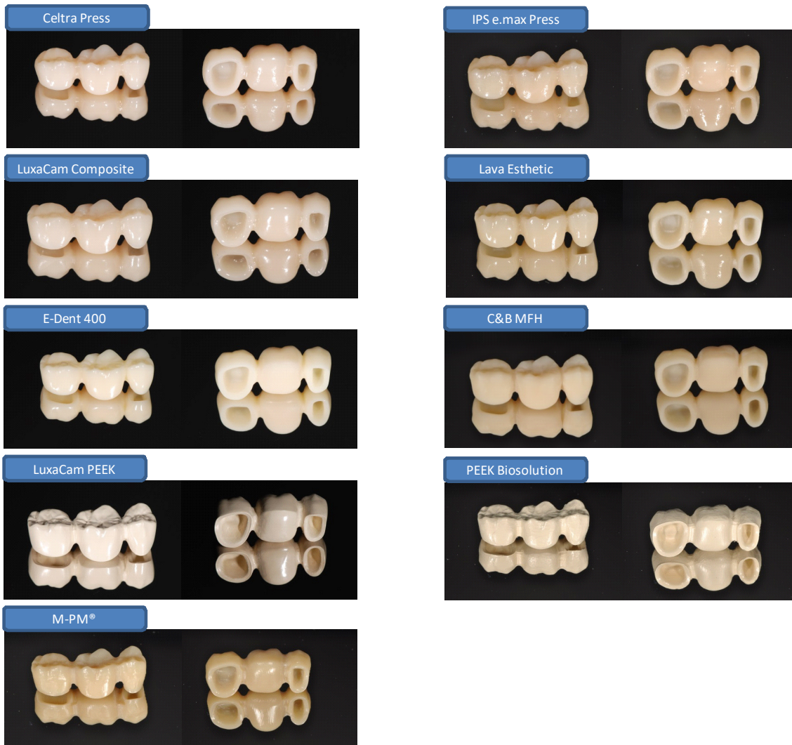
Abb. 4.9: Fertiggestellte Brücken vor Versuchsdurchführung
