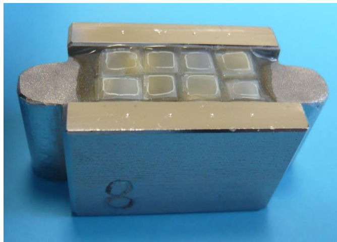
Abbildung 6 Foto eines Probenträgers. Die Referenzbohrungen und die dazu mittig ausgerichteten Proben mit ihrer adhäsiven Beschichtung sind zu erkennen.
